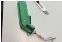
für die fachgerechte bearbeitung der systemelemente benötigen sie ein cuttermesser, sowie ein rillenschneidgerät mit 16 mm schneidspitze.
